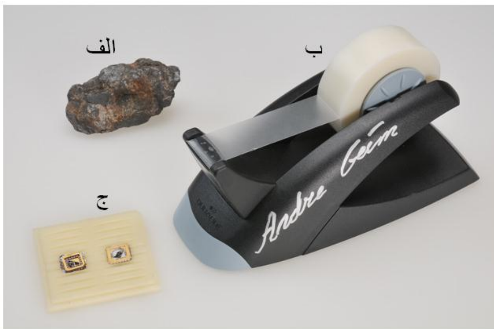
شکل ۲۹- الف) یک کلوخه از گرافیت، ب) چسب و ج) یک ترانزیستور گرافن
